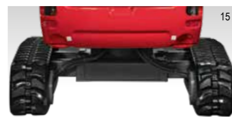
SZEROKOŚĆ ROZSTAWU GAŚNIEC 1.500 MM
