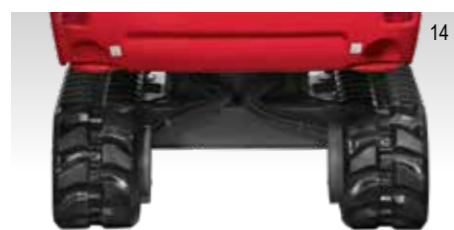
SZEROKOŚĆ ROZSTAWU GAŚNIEC 1.100 MM
