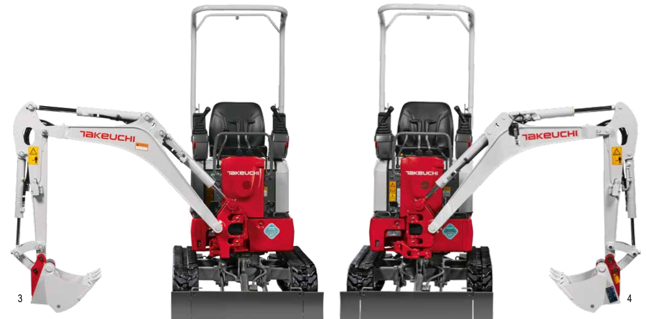
PRZESUNIĘCIE RAMIENIA W PRAWO O 85°
